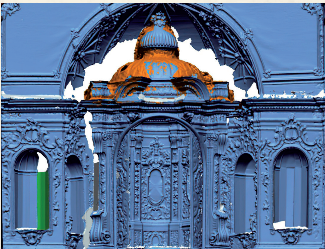
Figura 5. Datos azules de la medición láser escáner, datos en color naranja de las imágenes obtenidas por fotogrametría y la parte verde de la extrusión. (García-León et al., 2018).
